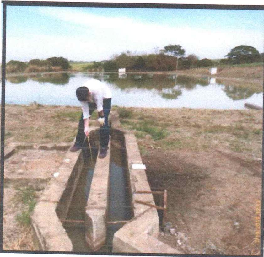
**Método Flutuador:** Consiste em determinar a velocidade de um flutuador no centro do curso do canal. Para efeito de campo, foi utilizado como flutuador uma bóia pequena de pesca para medir a
